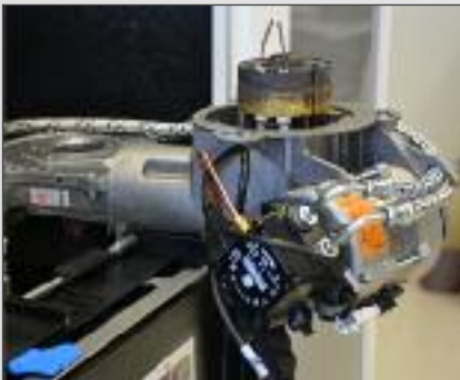
Verbrennungseinheit in Wartungsposition einhängen
