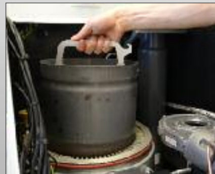
Brennkammer und Verdränger mit Wartungswerkzeug herausziehen
